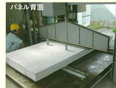
【コンクリートパネルの曲げ試験状況】
