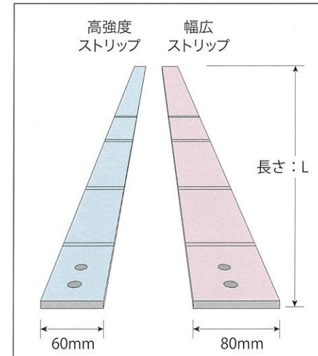
・壁上部のスキンはストリップ引張応力に余裕があるためA3タイプを用いて敷設間隔(75cm→1.0m)を広げる。
